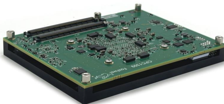
Рис 4 - 1 - Вариант отведения тепла с теплоотводящей пластиной
