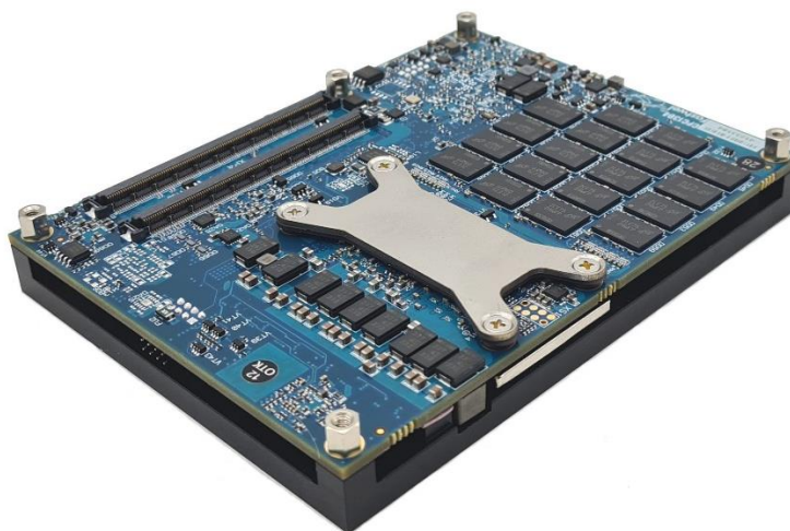
Рисунок 5 - Вариант отведения тепла с теплоотводящей пластиной
