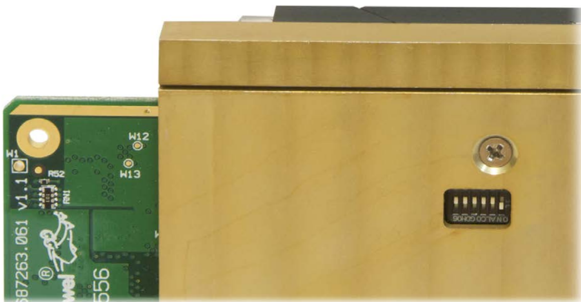
Рис. 4-2: Переключатель режимов работы модуля VIM556RC (SA1)
