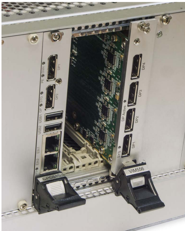
Рис. 3-1: Установка модуля VIM556
