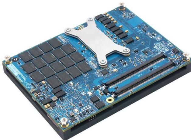
**Рис. 3 - 1 - Вариант отведения тепла с теплоотводящей пластиной**
