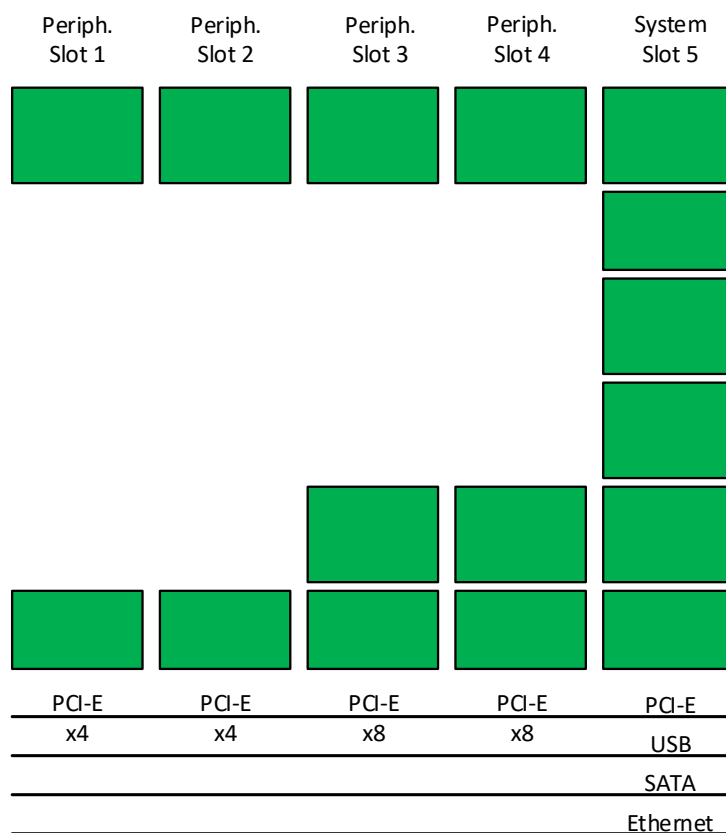
Рис. 2 - 4 – Схема распределения основных интерфейсов на слотах объединительной платы изделия
