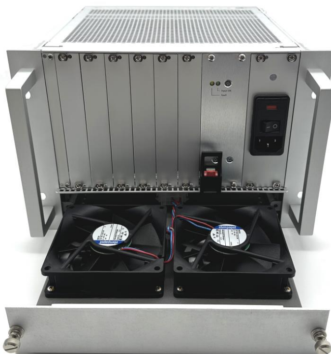
Рис. 2 - 2 Монтажный каркас 19"/2. Блок вентиляторов.
