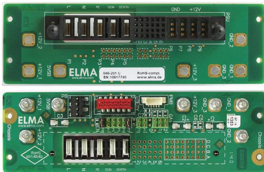
Рисунок 6 - Кросс-плата для подключения модуля (пример)
